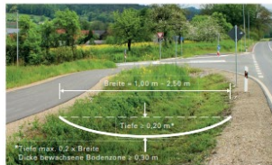
Abb. 10: Regelausbildung einer Regenmulde bei einem fahrbahnbegleitenden Geh- und Radweg außerorts
